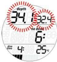
Die Warnmeldungen dauern an, bis der Taucher ausreichend weit aufgestiegen ist, dass der ppO<sub>2</sub> wieder innerhalb des zulässigen Bereichs liegt.
