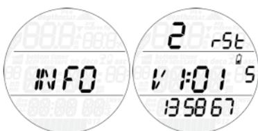
In diesem Untermenü werden Informationen über die Hardware und Software Ihres Puck Pro und den Ladezustand der Batterie angezeigt. Der Batteriestand wird mit einer Zahl zwischen 1 und 3 dargestellt, wobei 3 den höchsten Stand symbolisiert, 2 einem stetig angezeigten Batteriesymbol entspricht und 1 dem blinkenden Batteriesymbol (kein Tauchgang mehr möglich).
