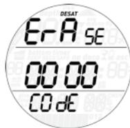
Puck Pro gibt Ihnen die Möglichkeit, die aktuellen Sättigungsdaten zu löschen. Alle Daten über die Gewebesättigung aus vorangegangenen Tauchgängen werden dabei auf null zurückgesetzt und der Computer berechnet den nächsten Tauchgang nicht als Wiederholungstauchgang. Die Funktion dient dazu, den Computer an einen Taucher zu verleihen zu können, der innerhalb der letzten 24 Stunden nicht getaucht hat.
