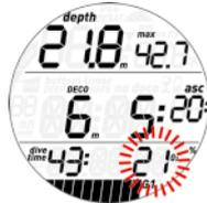
Wenn Sie die Taste während dieser Anzeige drücken, starten Sie dadurch den Gaswechsel: Nun blinkt der  $O_2\%$ -Wert von G2, wo zuvor der Wert von G1 geblinkt hat. In der oberen rechten Ecke werden, alle 2 Sekunden abwechselnd, die Buchstaben MOD und der MOD-Zahlenwert für G2 angezeigt.
