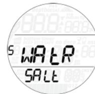
Je nach geplantem Tauchgewässer können Sie den Computer auf **FRESH (Süß-)** oder **SALT (Salzwasser)** Kalibrierung einstellen. Wenn die falsche Wasserart eingestellt ist, wird die Tauchtiefe um ca. 3 % falsch angezeigt (d. h. auf einer Tiefe von 30 m / 100 ft wird ein auf Salzwasser eingestellter Computer im Süßwasser 29 m / 97 ft anzeigen, während ein auf Süßwasser eingestellter Computer im Salzwasser 31 m / 103 ft anzeigt). Wichtig zu wissen ist dabei, dass dies keine Auswirkungen auf
