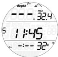
Im Modus „vor dem Tauchgang“ sehen Sie auf dem Display den P-Faktor, die eingestellte Bergseestufe, die Uhrzeit, die Dauer der Oberflächenpause seit dem letzten Tauchgang und die Temperatur. Wurde der Nitroxmodus aktiviert, sehen Sie auch den O<sub>2</sub>-Anteil und die zugehörige MOD. Ein kleines S bzw. F zeigt die eingestellte Wasserart an (S = salt - Salzwasser, F = fresh - Süßwasser).
