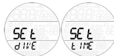
Um ein Menü zu öffnen, halten Sie die Taste gedrückt; um die verfügbaren Optionen nach oben oder unten zu rollen bzw. um einen vorgegebenen Wert zu vergrößern oder zu verkleinern, drücken Sie die Taste. Um die geänderte Einstellung zu speichern, halten Sie die Taste gedrückt. Um im Menü eine Stufe nach oben gehen, drücken Sie die Taste, bis auf dem Display **BACK (zurück)** erscheint, und halten dann die Taste gedrückt.
