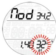
Innerhalb dieses Menüs können Sie den O<sub>2</sub>%-Wert durch Drücken der Taste verändern, und beobachten, wie sich dadurch die zulässige Maximaltiefe (MOD) verändert. Halten Sie dann die Taste gedrückt, um zur Einstellung des ppO<sub>2</sub>max weiterzuschalten. Benutzen Sie zum Ändern des Wertes die Taste. Auch hier sehen Sie, wie sich dadurch die zulässige Maximaltiefe (MOD) verändert. Halten Sie die
