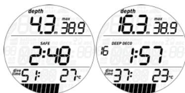
Bei **DEKO**stopps werden nur die Minuten angezeigt, da die tatsächliche Dauer der Dekompensationsstopps von der exakten Tiefe abhängt.
