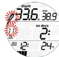
Wenn auf Tiefen über 12 m / 40 ft schneller als mit 12 m/min / 40 ft/min aufgetaucht wird, blinkt auch das Symbol . Wenn eine Aufstiegs geschwindigkeit von über 12 m / 40 ft über mehr als zwei Drittel der Tiefe, auf der die Warnmeldungen zum ersten Mal ausgelöst wurden, beibehalten wird, wertet dies der Puck Pro als Tauchgangs verstöß und auf dem Display wird das Symbol dauerhaft angezeigt.
