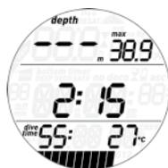
Bei der Rückkehr zur Oberfläche schaltet der Puck Pro zunächst in den Modus „Erreichen der Oberfläche“. Dieser Modus erlaubt Ihnen, nach einer kurzen Orientierung wieder abzutauchen und den Tauchgang fortzusetzen. Das Display zeigt dabei einen 3-Minuten-Countdown.
