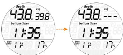
Wenn Sie die Taste gedrückt halten, während die Uhrzeit angezeigt wird, wird die Stoppuhr neu gestartet.
