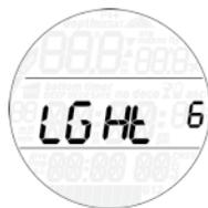
Der Puck Pro hat eine Displaybeleuchtung, die Sie bei schlechten Lichtverhältnissen einschalten können. Halten Sie dazu die Taste gedrückt. Während eines Tauchgangs bleibt die Displaybeleuchtung so lange, wie in diesem Menü eingestellt, eingeschaltet. Sie können einen Wert zwischen 1 und 10 Sekunden oder **on (ein)** einstellen. Wenn Sie die Displaybeleuchtung auf **on (ein)** stellen, bleibt sie eingeschaltet, bis Sie erneut die Taste gedrückt halten.
